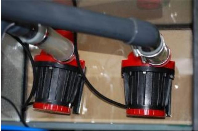
Elles servent en même temps au flux dans le bac pour éviter les pompes disgracieuses à l'intérieur du bac et aussi pour la circulation d'eau dans la décantation. Ce qui est un problème pour avoir un flux d'eau maximum dans le bac. Cela joue trop sur les niveaux d'eau dans la décantation. Au lieu d'avoir 2 pompes pour la filtration (ce qui est une sécurité en cas de panne), je mettrais aujourd'hui 1 pompe en close loop et une autre pour la filtration!
