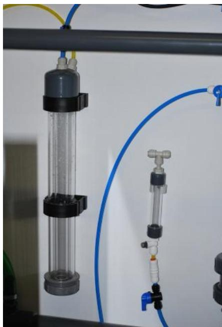
Les raccords 40mm/1/4 de Neo3+, bien pratique pour éviter des pompes supplémentaires et qui profitent du flux de la pompe de remontée pour diriger de l'eau vers le RAC, le filtre à phosphate et un de réserve au cas où... Pas besoin d'autres pompes.
